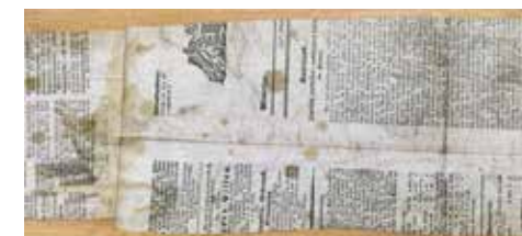
Zeitungsstreifen von 1854 und beschriebenes Papier zur Abdichtung des Blasbalges
