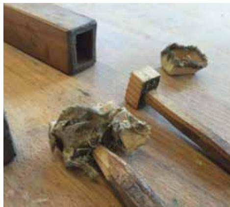
Holzpipe mit Stöpsel und alter Stoffdichtung
