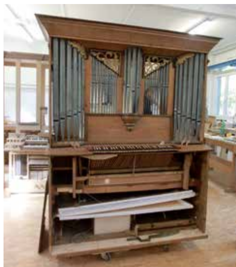
Orgelgehäuse mit Blasbalg und Motor
