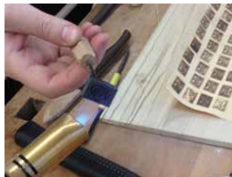
Einbrennen des Musters auf Papier für die Tastenfronten
