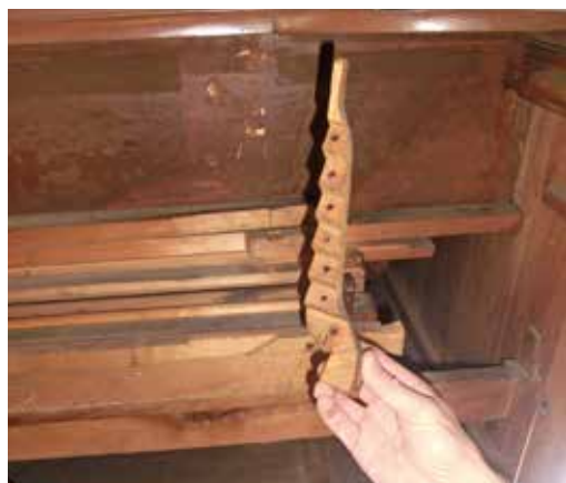
Demontage der Mechanik: schräg laufende Stecher und fächerartig eingebaute Wellen sowie der treppenförmige Wellenhalter zeigen die kreative Lösungsfindung.
