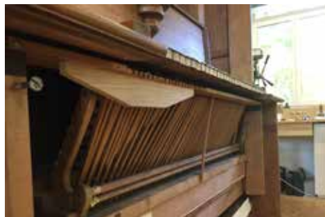
Klavatur mit Stechermechanik
