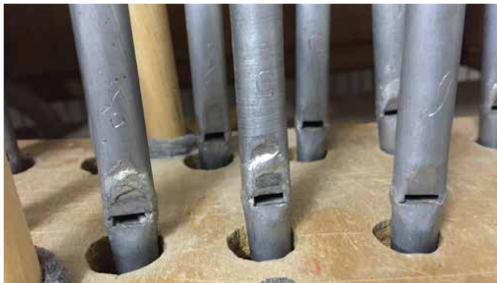
Schadhafte Metallpfeifen vom 2'
