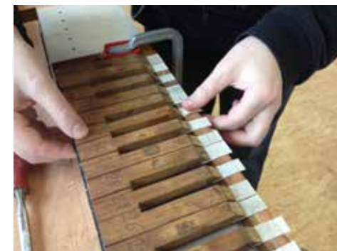
Klaviaturunterseite mit Pergament-Scharnieren
