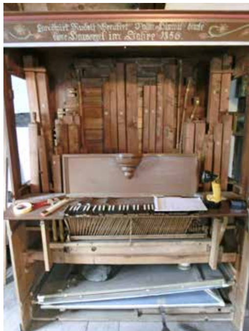
Demontage der Mechanik: schräg laufende Stecher und fächerartig eingebaute Wellen sowie der treppenförmige Wellenhalter zeigen die kreative Lösungsfindung.
