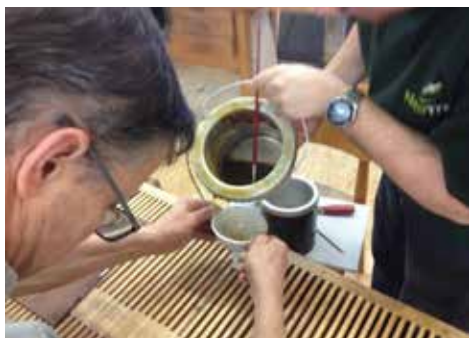
Abdichten der Windlade mit Leim
