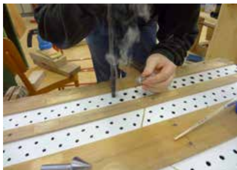
Ausbohren der Schleifenbohrungen in der neu mit Schafleder abgedichteten Schleifenbahn
